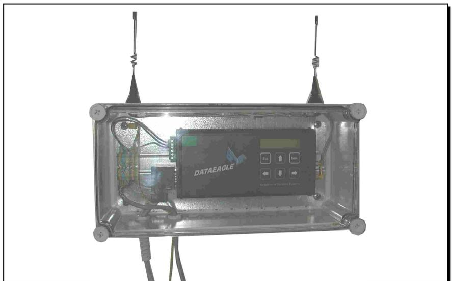
Abb. 4.1: Funkeinheit für den Außenbereich
