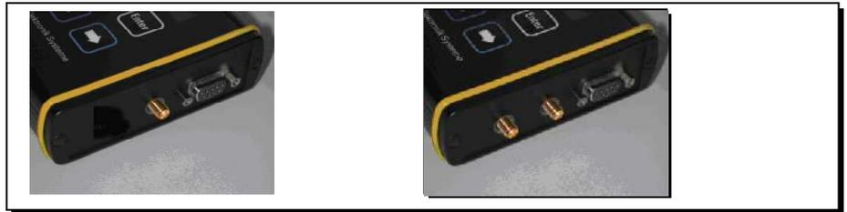
Abb. 4.2: Funkmodem mit einem Antennenanschluss
